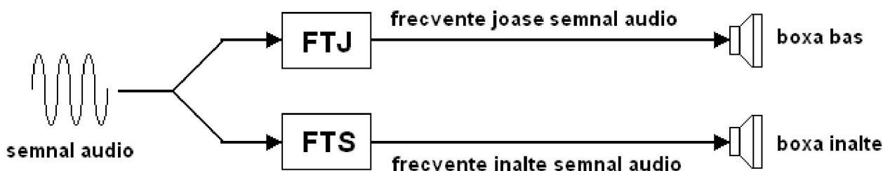
Structura simplificată a ieșirii unui sistem audio
